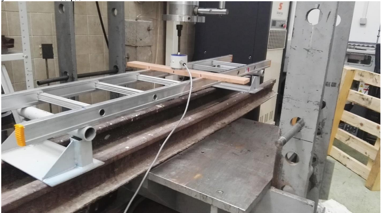
Слика 2 Конфигурација мерења носивости мердевина
