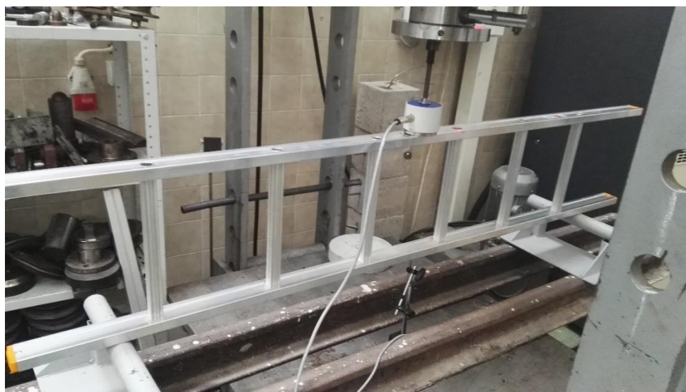
Слика 8. Мерење угиба у бочном правцу мердевина
