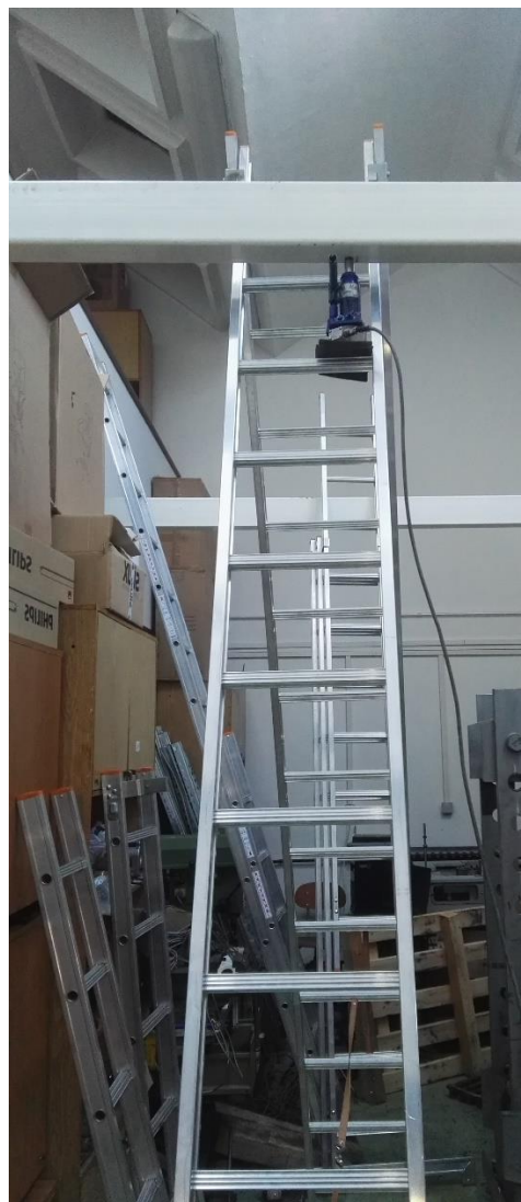
Слика 12 Испитивање дводелних -подбочних мердевина ДАС Прамоал д.о.о. вертикалном силом у отвореном стању
