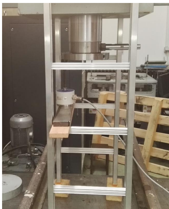
Слика 6. Тест оптерећења мердевина уз носач (50мм).
