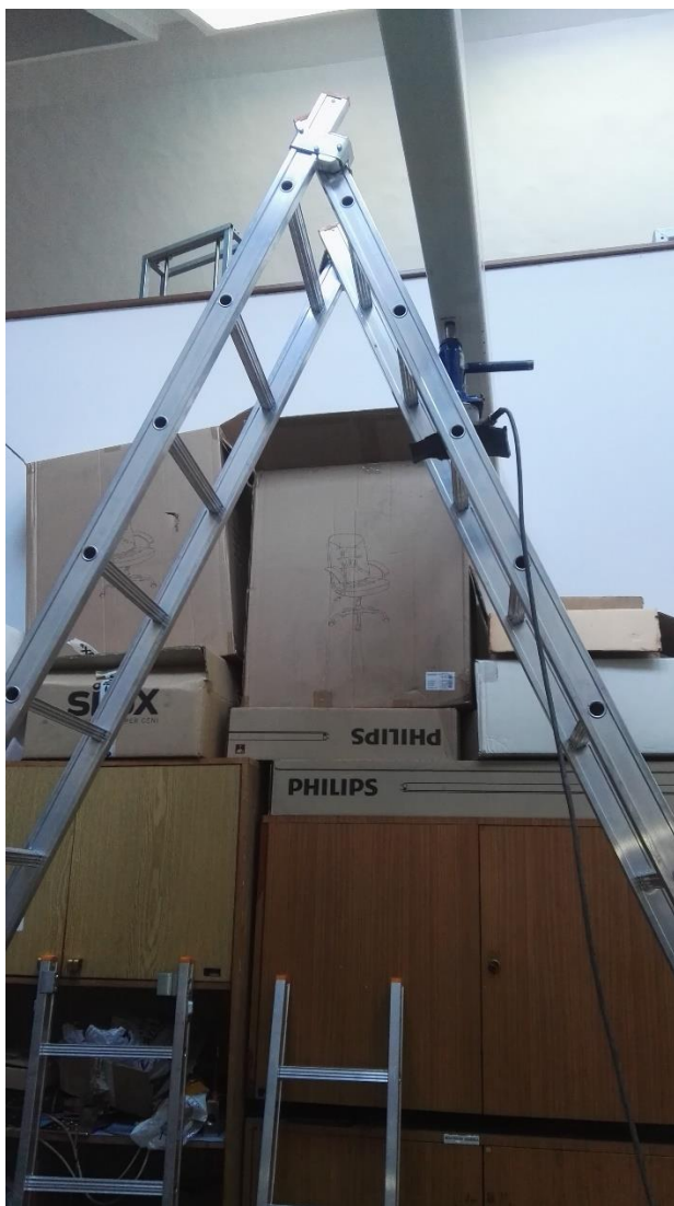
Слика 12 Испитивање дводелних -подбочних мердевина ДАС Прамоал д.о.о. вертикалном силом у отвореном стању
