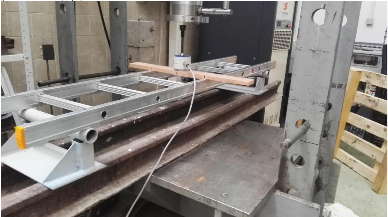
Слика 2 Конфигурација мерења носивости мердевина
