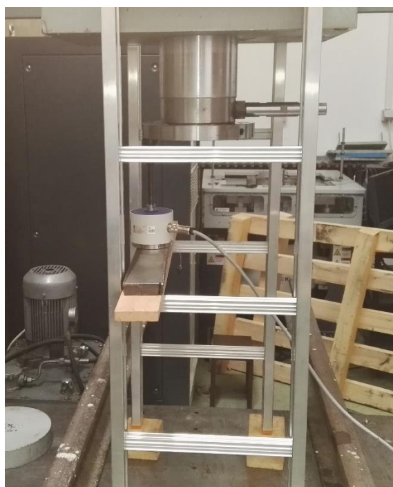
Слика 6. Тест оптерећења мердевина уз носач (50мм).
