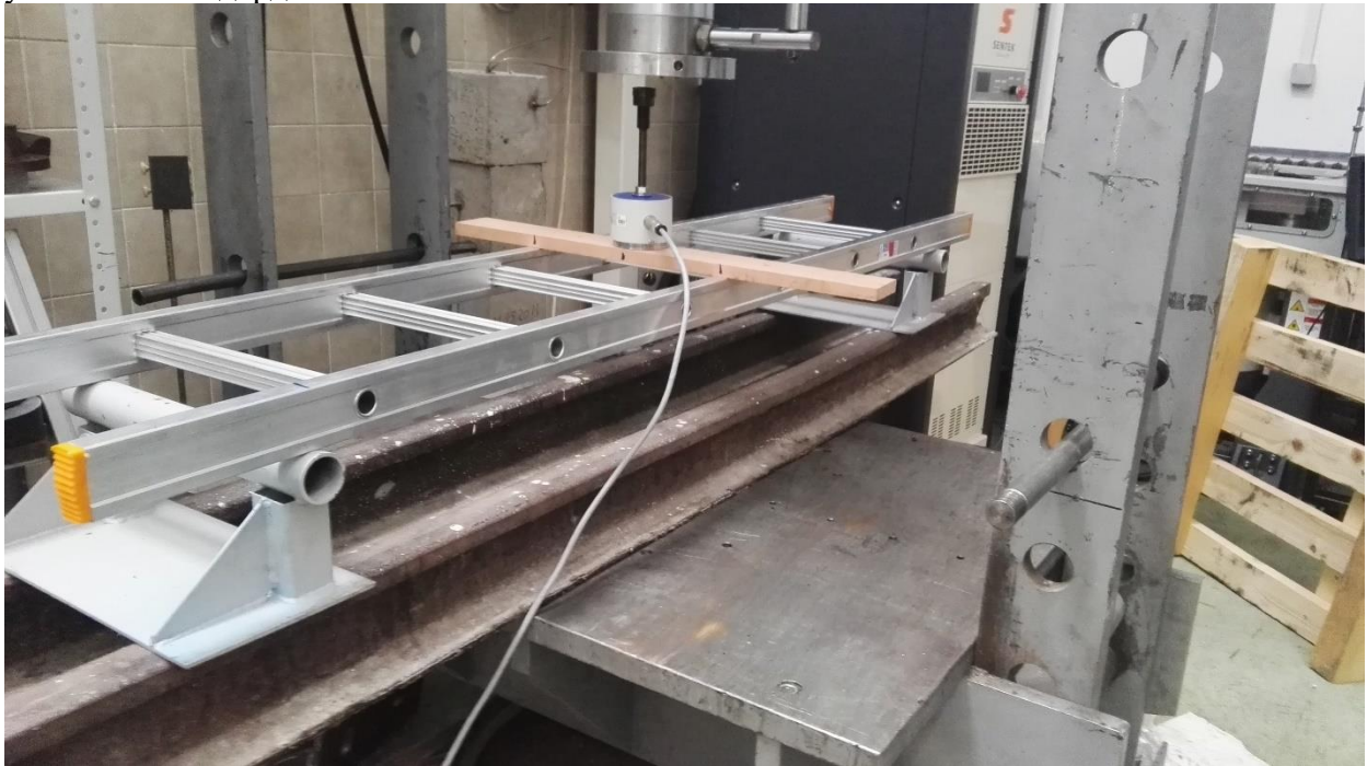
Слика 2 Конфигурација мерења носивости мердевина
